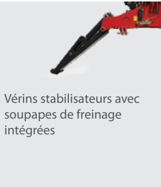
Pieds stabilisateurs de construction robuste, qui assurent la stabilité du positionnement même en zone de travail inégale.
