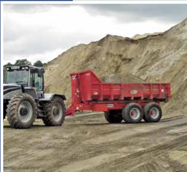
Les remorques illustrées sur les figures précédentes sont équipées d'une suspension à deux essieux.
